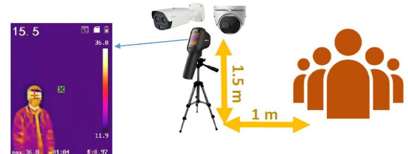
Remarque: il est recommandé une distance de 1,2 mètre entre la caméra thermique et le sujet testé.
